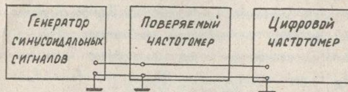
Рис.4.Схема проверки аналогового частотомера
