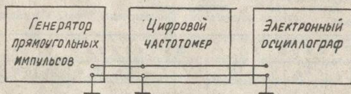
Рис. 5. Схема измерения периода и длительности электрических сигналов
